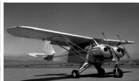
Un'altra macchina del genere fu ricavata dal Piper, negli anni '60 la "*Nelson engines co*" modificava un J3c-65 applicando due dei suoi motori 4 cilindri a 2 tempi di 48hp l'uno. Così trasformato riusciva a decollare in circa 60-70 metri, salire a ben 1800 fpm, tenere in crociera gli 85 mph e atterrare a 50 mph, la velocità di stallo si attestava a 38 mph, il consumo nonostante i due motori, (a due tempi) riusciva mantenersi su 20 litri/ora.
